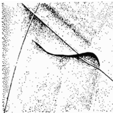
Рис. 6.5. Пробоина в бортовой обшивке судна, полученная в результате столкновения
